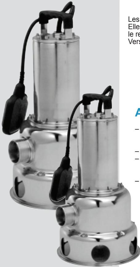
Les pompes de la série sont entièrement construites en acier inox AISI 304. Elles travaillent en immersion complète dans le liquide pompé qui assure de l'extérieur le refroidissement du moteur. Réalisée avec roue vortex. Version automatique (AUT) équipée d'un interrupteur à flotteur.
